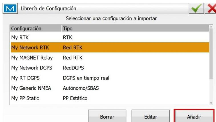
Crearemos un nombre para la configuración, en este ejemplo hemos puesto HxGN SmartNet, en tipo indicaremos “Red RTK”, el tipo de correcciones indicaremos “VRS” para correcciones de red o “Base Única” para base simple y el protocolo en NTRIP.
